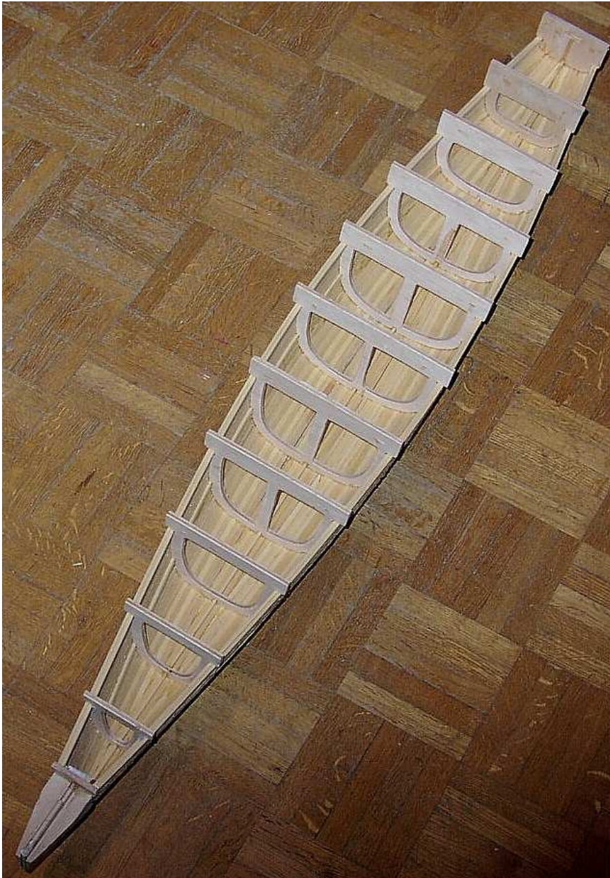
Scafo appena tolto dal piano di montaggio
