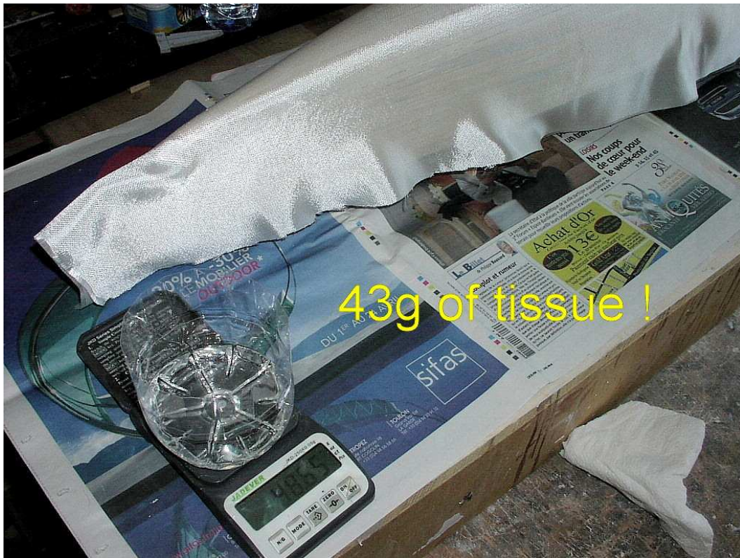
Preparazione della resina sulla bilancia di precisione. In questo caso ci sono 48g di resina per 43g di tessuto. Per il master non é necessario un controllo stretto del rapporto 50/50
