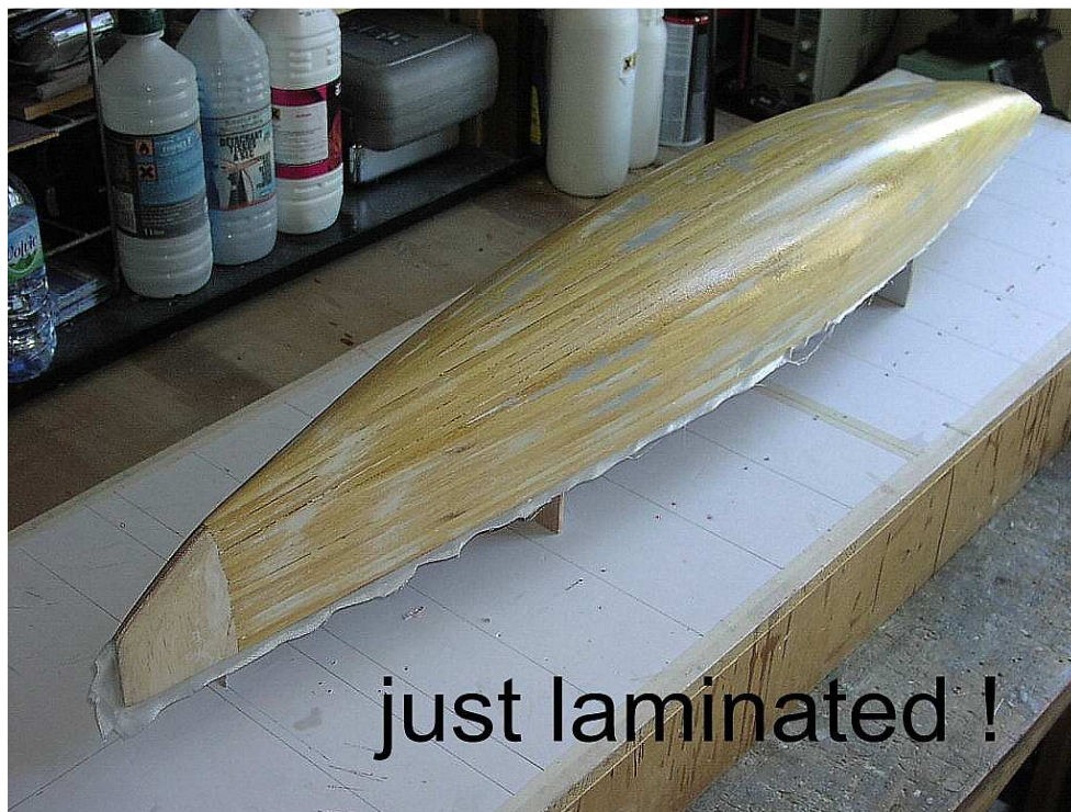
Lo scafo é laminato, Il carteggio all'acqua inizierà dopo la polymerizzazione e l'applicazione di un fondo per vernici che io trovo in bomboletta
